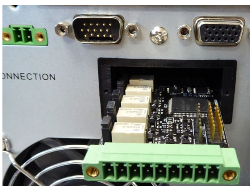
Fig. 8. Insertion de la carte NIMBUS AS400
